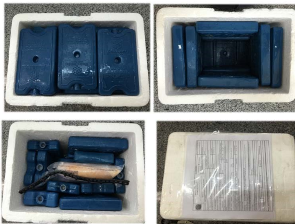
Figura 1.7 – Acondicionamento da amostra em caixa de isopor e fixação do documento SOA na superfície externa da caixa de envio da amostra.
